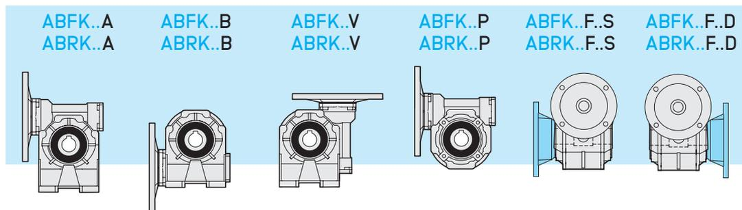
Per le dimensioni, gli accessori e le posizioni di montaggio vedere il "Catalogo dei Riduttori a Vite Senza Fine Tramec".
